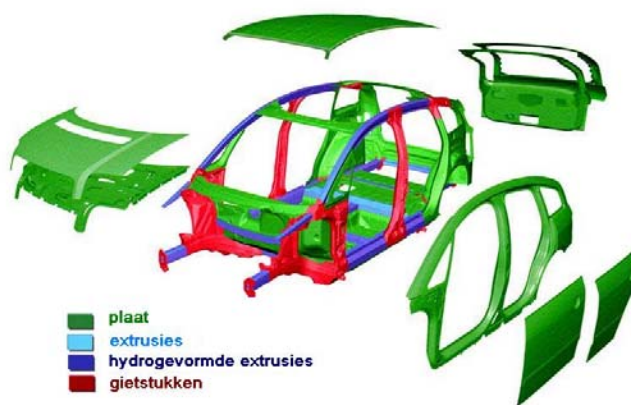
figuur 16 Spaceframe van de Audi A2
