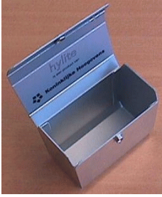
figuur 21 Een opbergdoosje. De vouwnaden en scharnieren van het doosje zijn gemaakt door de huidplaat plaatselijk weg te frezen (zie rechts)
