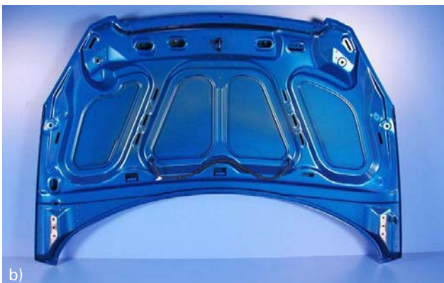
figuur 17 Motorkap van de Peugeot 307. Buitenkant (a) en binnenkant (b). Buitendeel EN AW-6016 T4. Binnendeel EN AW-5754 O. Gewicht 8,2 kg
